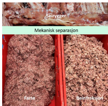
Figur 1 Seirygger før og etter mekanisk separasjon med skrueseparator.
