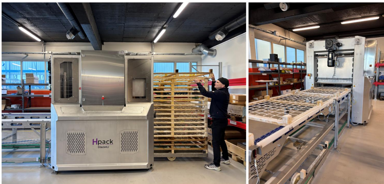
Figur 8: Plassering av tom tørkerivogn i innmatingsenhet (venstre). Utmating av tørkebrett (høyre).
